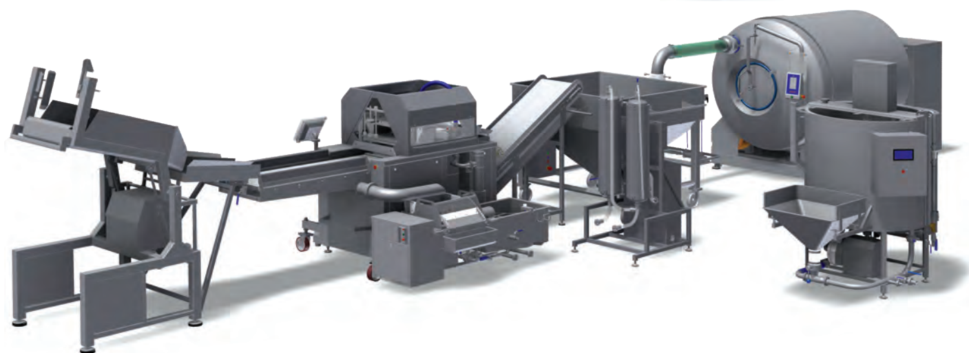
line for industrial injection of chicken breast and chicken nuggets línea industrial de inyección de filetes de aves y de los productos tipo nuggets
