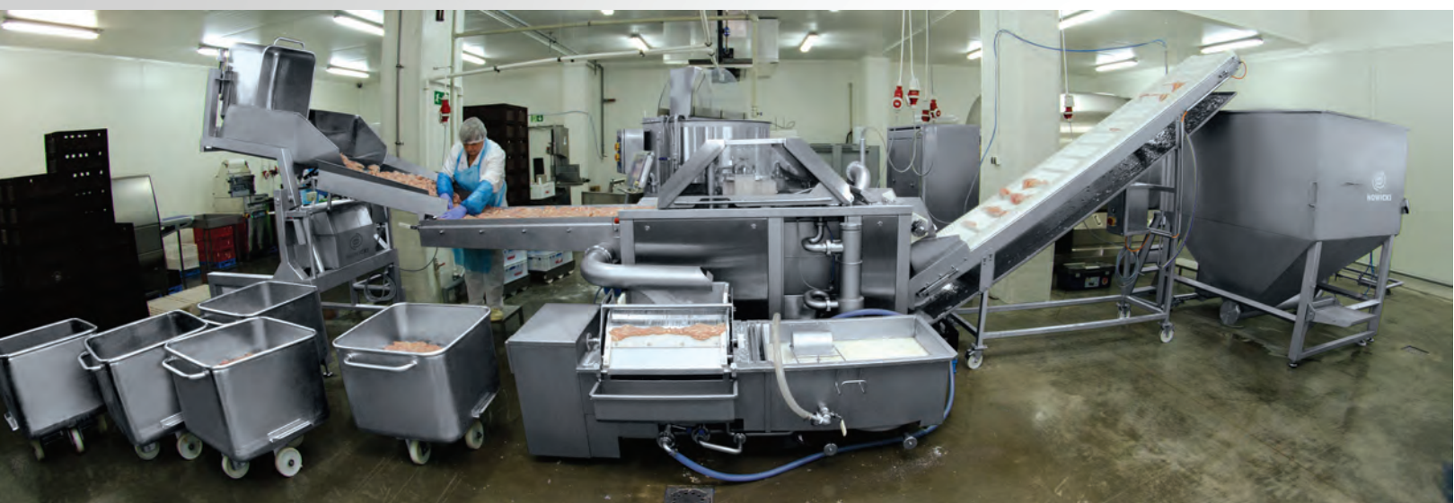
line for industrial injection of chicken breast and chicken nuggets línea industrial de inyección de filetes de aves y de los productos tipo nuggets
